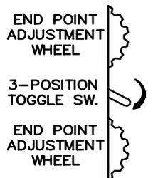
4. PRESS THE TOGGLE SWITCH ALL THE WAY TOWARDS THE OTHER WHEEL, PAST THE CENTER POSITION. THE MOTOR WILL RETURN THE LENS TO THE ORIGINAL STARTING POINT.
